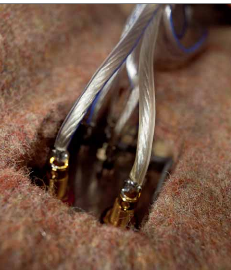
Saubere Kontaktstellen und aufwendige Bedämpfung im Inneren
