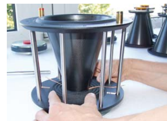
Oben: Der DDD wird erst kurz vor der Fertigstellung zentriert, teilweise in Handarbeit.
